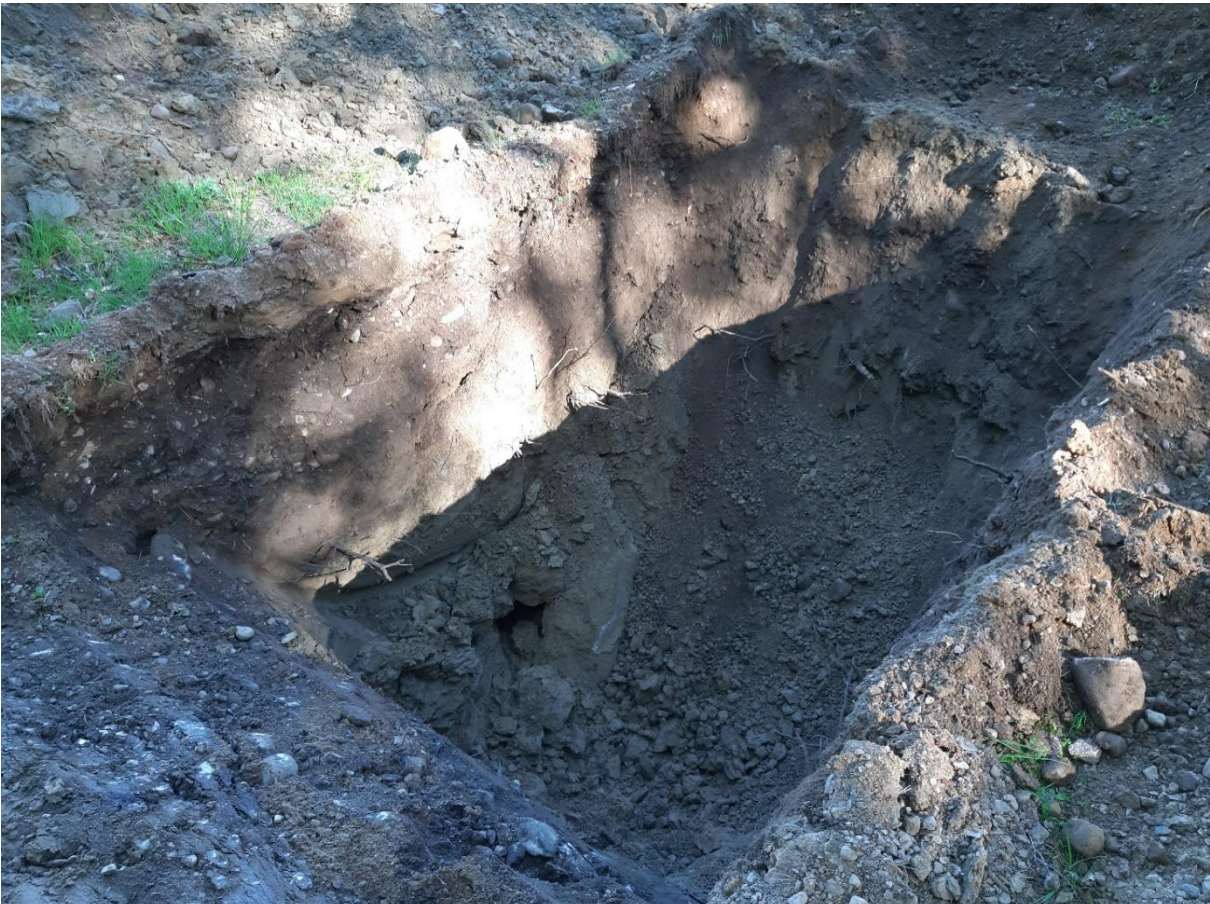
Kuva 18. Koekuoppa SW15. Maakerroksissa todettiin polttoaineen hajua ja kohonneita öljyhiilivetyjen pitoisuuksia.
