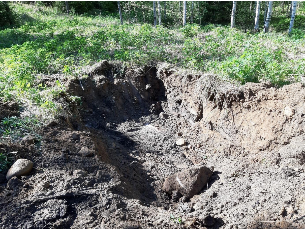
Kuva 22. Koekuoppa SW18. Kohdassa todettiin kallion pinta.
